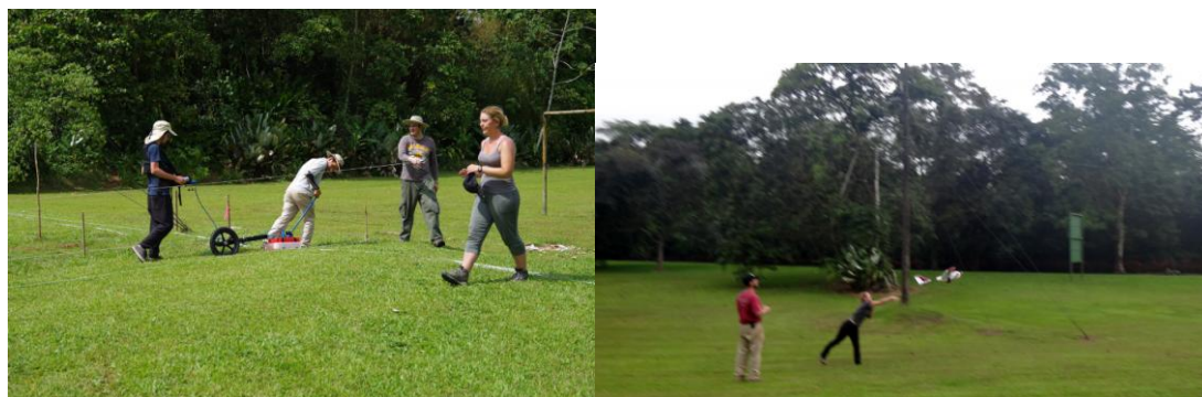
Figura 1. Uso del radar de penetración del suelo donado al Museo Nacional de Costa Rica, sondeo de la calzada Pocora junto a la cancha de fútbol, sector Mercedes de la Universidad EARTH, sitio Las Mercedes-1 (L-289 LM-1). Figura 2. Aplicación de sensores remotos mediante un vehículo aéreo no tripulado ( drone ), con sensores de espectros múltiples, sitio Las Mercedes-1 (L-289 LM-1).
